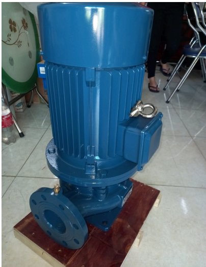
Vít xả khí bằng đồng trên thân bơm, móc cầu trên động cơ, để chân bắt bulông.
